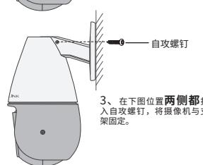
3、在下图位置两侧都打入自攻螺钉，将摄像机与支架固定。
