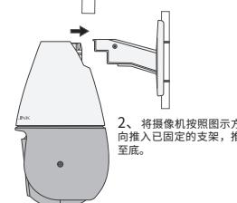
2、将摄像机按照图示方向推入已固定的支架，推至底。
