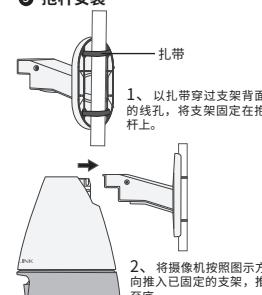
1、以扎带穿过支架背面的线孔，将支架固定在抱杆上。
