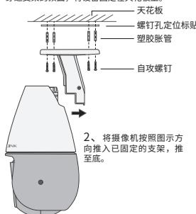
2、将摄像机按照图示方向推入已固定的支架，推至底。
