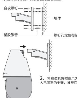
2、将摄像机按照图示方向推入已固定的支架，推至底。
