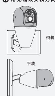
请用户按照说明书方式正确安装，禁止错误方向安装，否则存在因进水导致设备报废风险！
